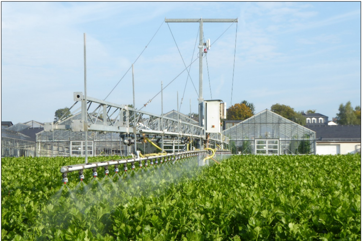
Abbildung 4: Computergesteuerter Gießwagen zur Bewässerung der Parametrisierungs- und Evaluierungsversuche am Standort Geisenheim, hier mit Stangensellerie (Quelle Foto HGU)
